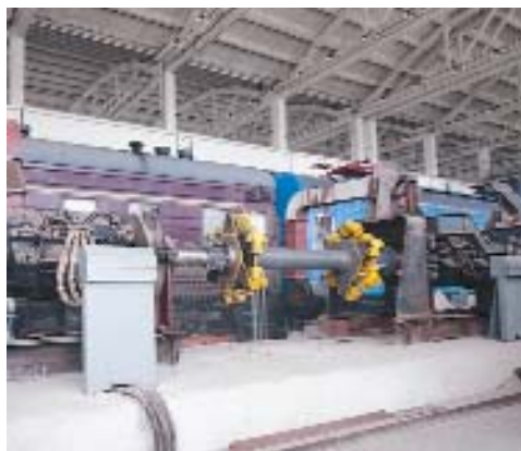
Стенд для испытания колесно-моторных блоков и тяговых трансмиссий
