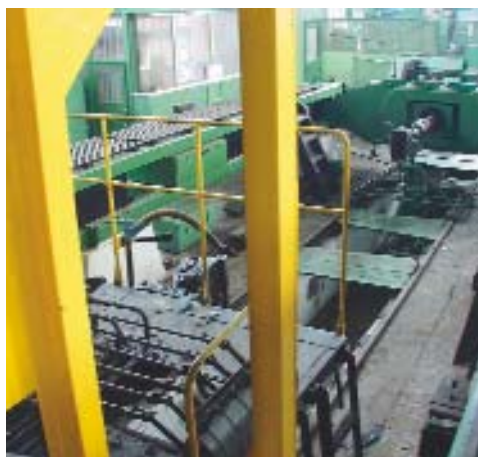
Стенд-пресс для испытания вагонов
