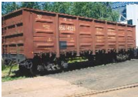
Цельнометаллический полувагон с глухими торцовыми стенками
