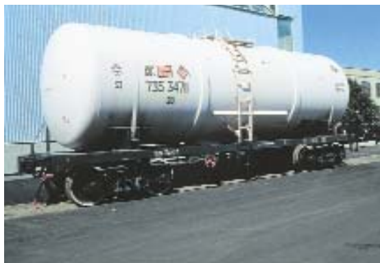
Цистерна с увеличенным объемом котла
