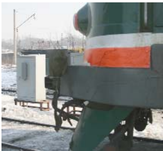
Пункт считывания САИ подвижного состава
