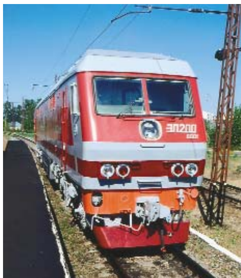
Электровоз ЭП200 с синхронными тяговыми двигателями
