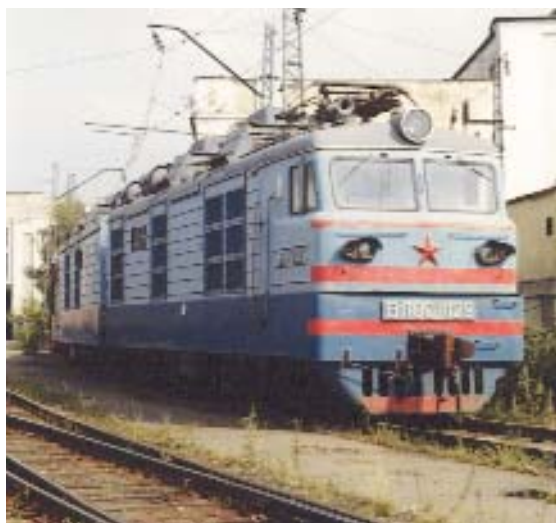
ВЛ80В — грузовой электровоз переменного тока с вентильными тяговыми двигателями
